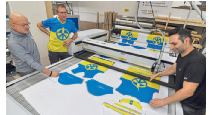
„Fast 52“-Mitarbeiter Hamid Khosh Ghadam (rechts) kontrolliert den Lasercutter. Der schneidet die aufgedruckten Einzelteile aus dem Recycling-Material. Verschnitt dient später als Kissenfüllung.
